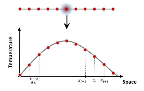
$$\frac{\partial^2 T}{\partial x^2} \approx \frac{T_{i+1}^n - 2T_i^n + T_{i-1}^n}{\Delta x^2}$$
